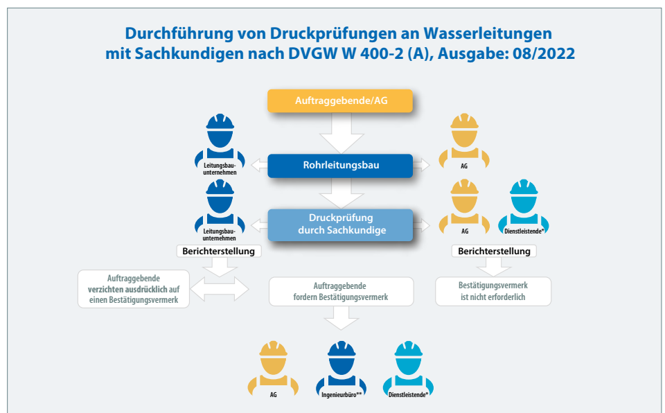
Grafik 1: Durchführung von Druckprüfungen an Wasserleitungen mit Sachkundigen nach DVGW-Arbeitsblatt W 400-2 (A)
