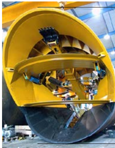
Abbildung 3: Teilschnittmaschine DA 4700 mit Zwischenbühne (Quellen 3+4: Fa. EPPING)
