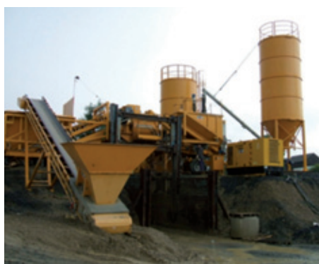
© Feickert GmbH, Abb. 4 | Semimobile Mischanlage zur Herstellung von ZFSV
