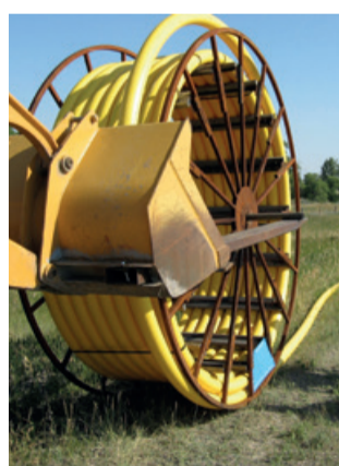
Eine Rolle fasst bis zu 200 m Rohrleitung aus PA12. Im Unterschied dazu passen Stahlrohre mit einer maximalen Länge von 18 m auf einen Lkw.
