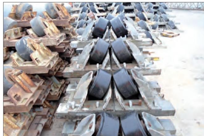
Über Rollenböcke wurden die rund 90 m langen Rohrstränge nacheinander in den 1.250 m langen Tunnel eingezogen. (Bild: Reinhard Rohrbau)
