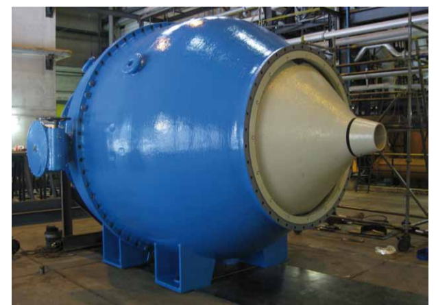
Ein technisches Meisterwerk: Die jeweils 22 t schweren Ringkolbenventile haben eine Baulänge von 3,80 m und einen Außendurchmesser von 3,23 m. Sie bestehen aus einem Stahlgehäuse, in dessen Innenraum sich ein frei laufender Kolben, der sogenannte Plungerkörper, bewegt. (Foto: RAC)
