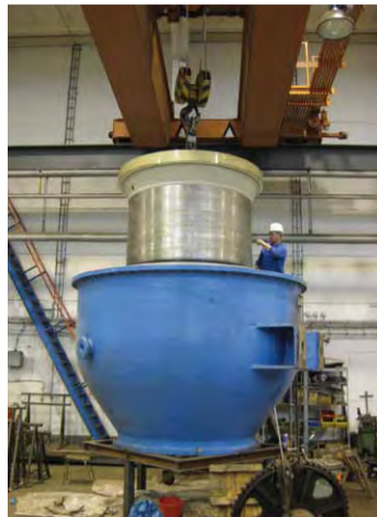
Bei RAC wurde der Plungerkörper demontiert, alle noch nutzbaren Bauteile grundüberholt und defekte Teile ausgetauscht. (Foto: RAC)
